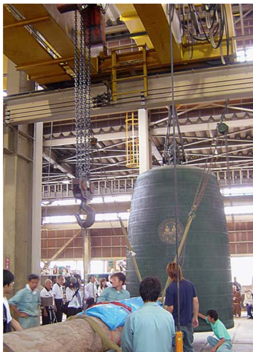
老子製造所工作人員合抱撞木，為法華鐘進行撞鐘測試。
